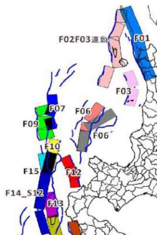
よって、本計画においては、岩内町への影響が高いとされた「F12」及び「F15」を想定津波断層モデルとし、その津波シミュレーション結果を想定津波として設定するものとする。
