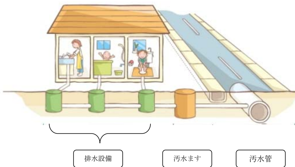
図 下水道のしくみ
