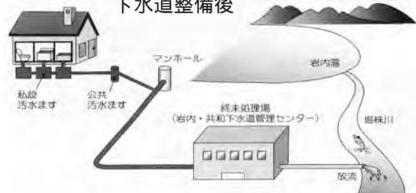
各家庭から排出された污水・雑排水は下水道を通り、下水道センターでキレイな水に処理後、堀株川へ放流します。
